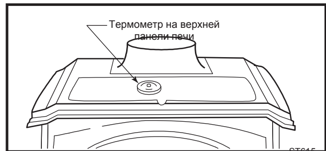
Рис. 31 Термометр дает информацию о температуре печи, помогающую эффективно и безопасно эксплуатировать изделие.
