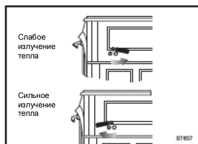
Фигура 34 The Ручка может быть установлена в любом направлении между крайними точками для разных уровней излучения тепла.
